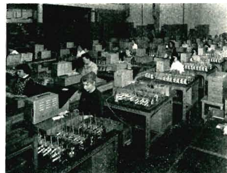
Fig. 3 - Collaudo dei gruppi a radio frequenza per VHF.
