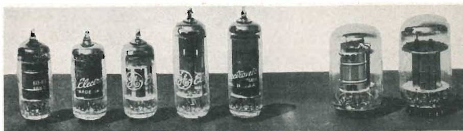
Ben 5 valvole miniatura possono essere sostituite da 2 soli compactron.
