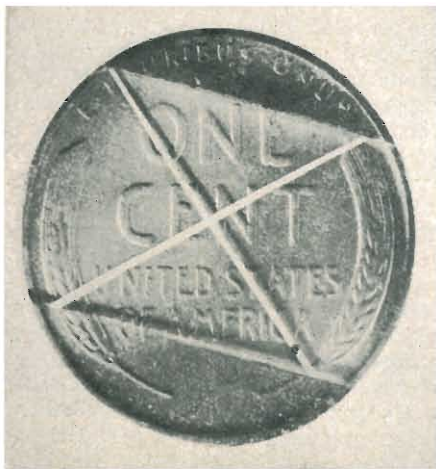
Le piccolissime dimensioni del dispositivo che potrebbe essere realizzato traendo vantaggio dalle recenti scoperte sulla superconduttività e sull'effetto del tunneling possono essere osservate su questa foto. Due piccolissime striscie metalliche sono disposte su una lastrina di vetro. La parte operante è solo l'incrocio.
